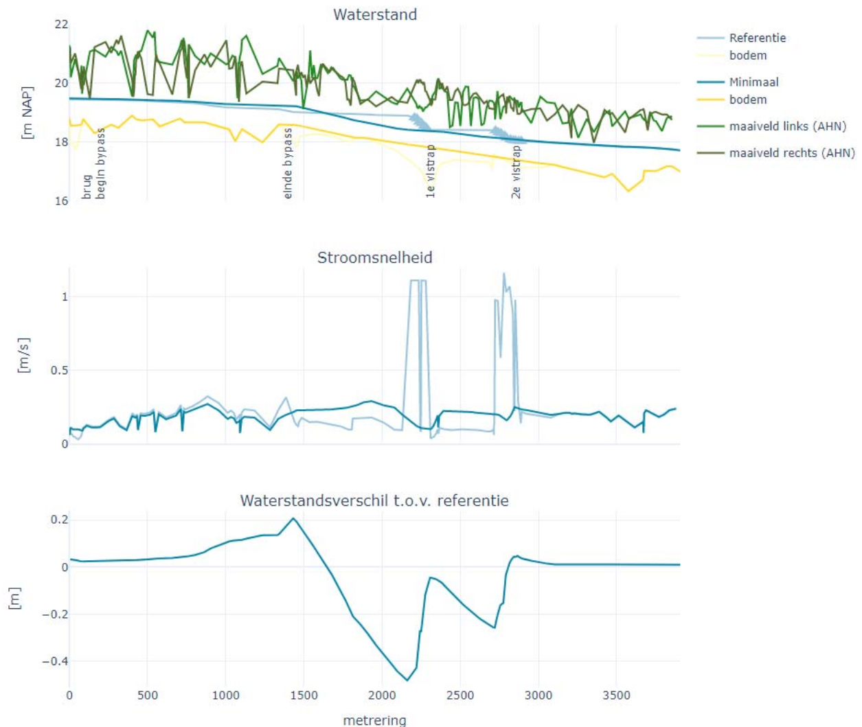
Figuur 13 Verschil in waterstand en stroomsnelheid tussen referentie en minimaal scenario in zomersituatie
